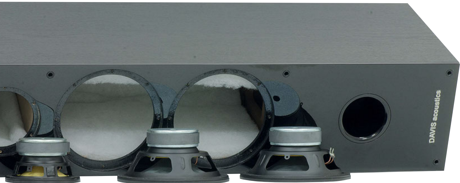
Il diffusore smontato con tutti i componenti. Notiamo il buon complesso magnetico del tweeter, i cestelli in lamiera stampata del midrange e dei woofer e l'assorbente utilizzato per l'interno. Si tratta di assorbente acrilico di una discreta consistenza.
