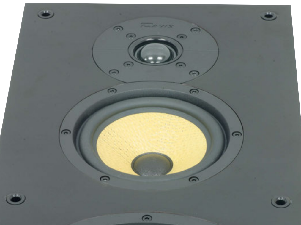
L'unità medio-alti composta dal midrange e dal tweeter. Notare come la flangia del tweeter sia modellata per avvicinare i centri acustici degli altoparlanti.
