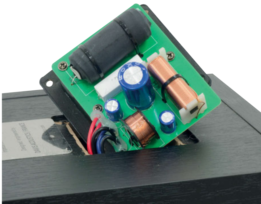
Rimossa la vaschetta posteriore, vediamo che il filtro crossover è fissato sul retro. Notare le induttanze avvolte su nucleo, tranne quella del tweeter, e la presenza di condensatori elettrolitici bipolarizzati.
